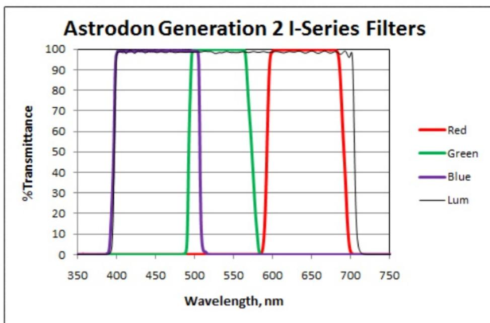
E系的滤镜红色更窄，I系的滤镜红色透过谱线更宽。这里有一个没经过严格证明的结论（有错请指出）：**我们认为一组滤镜的色相由透过谱线的中心波长决定，而饱和度由滤镜的透过带宽决定。**这个推测是基于以下事实：
